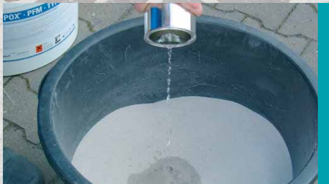
Kuva 2: Seuraavaksi lisätään sideaine, ilman veden lisäystä, mukana olevasta purkista.
